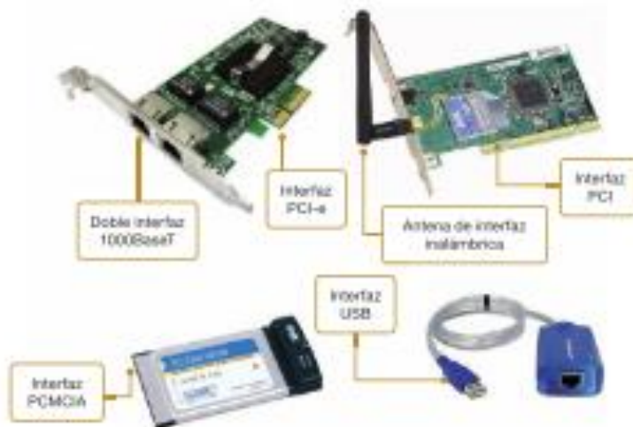
Fig. 2.7. Adaptadores de red con interfaz PCI-e para cable UTP con doble puerto Ethernet (arriba izquierda), para redes inalámbricas con bus PCI (arriba, derecha), con interfaz PCMCIA para portátiles (abajo, izquierda) y con interfaz USB (abajo, derecha).
