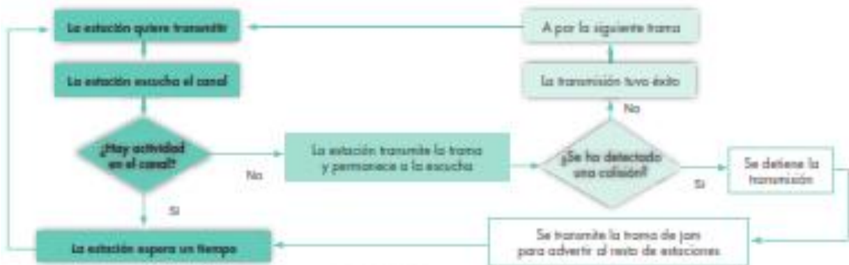
Fig. 2.11. Diagrama de bloques del proceso de contención CSMA/CD.
