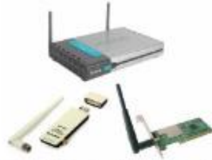
Fig. 1.3. Dispositivos inalámbricos utilizados en redes de área local: punto de acceso con doble antena (arriba), tarjeta de red inalámbrica con interfaz USB (abajo, a la izquierda) y tarjeta de red PCI con interfaz inalámbrica de una única antena (abajo, a la derecha).
