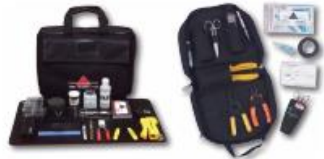
Fig. 3.6. Kits de conectorización de fibra óptica (a la izquierda) y de cables de pares (a la derecha).
