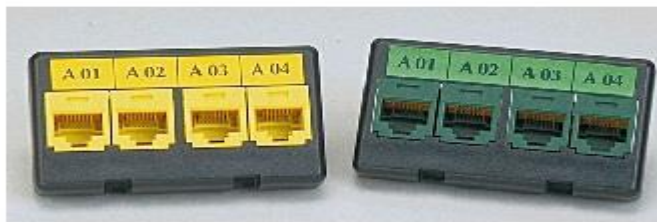
Ejemplo de etiquetas con código de color para facilitar la identificación
