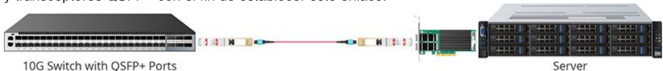
Imagen 3: La tarjeta de red de 40Gb utiliza un cable de fibra MTP para completar la transmisión
